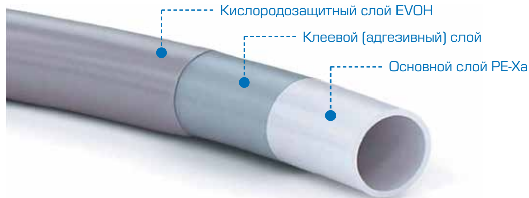
Рис. 2.1. Трехслойная труба РЕ-Ха/EVONH
